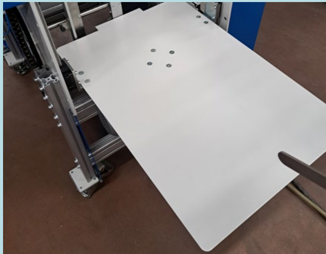
Wydłużony podajnik (do 1050 mm)
